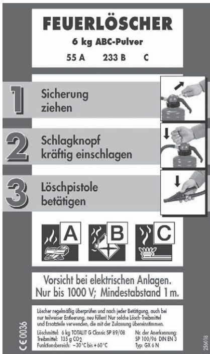
Bild 2: Beispiel einer Kennzeichnung auf einem Feuerlöscher (Quelle: Fa. TOTAL)
