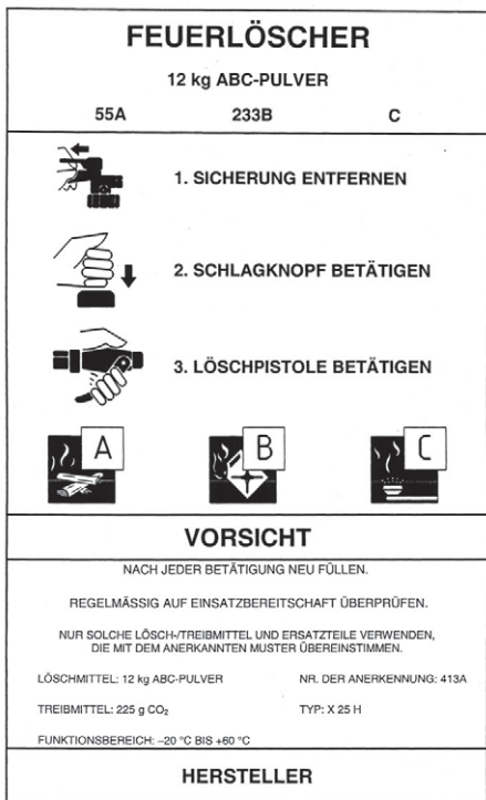
Bild 17: Beispiel einer Kennzeichnung auf dem Feuerlöscher (Quelle: DIN EN 3-7)
