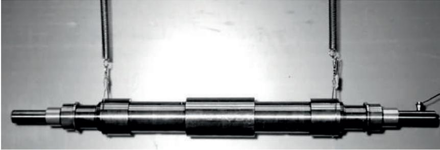
**Bild 1:** Elastisch aufgehängte Motorwelle
