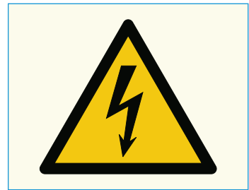
Bild 1: Warnung vor gefährlicher elektrischer Spannung
