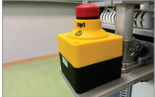
Bild 1: Schalter für Handlung im Notfall [www.pilz.com](http://www.pilz.com)
