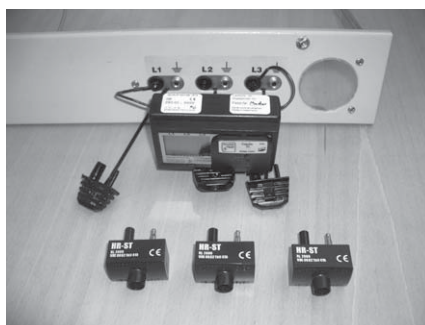
Bild 10.4a Eigensicheres Spannungsprüfsystem zur Nachrüstung und als Ersatz für die darunter abgebildeten HR-Anzeigergeräte nach DIN EN 61243-5 ( VDE 0682-415 ).
