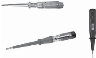
Bild 10.5 Einpolige NS-Spannungsprüfer (Phasenprüfer) sind zum Feststellen der Spannungsfreiheit – entsprechend der dritten Sicherheitsregel – unzulässig!
