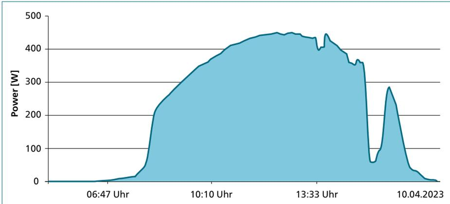
**Abbildung 5.1** Ertragskurve eines Balkonkraftwerks (Südausrichtung) im Tagesverlauf
