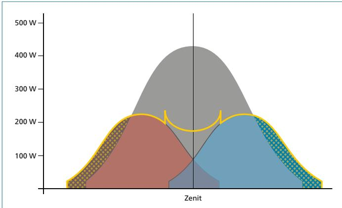
**Abbildung 5.3** Idealisierter Ertrag aus Süd-Ausrichtung (grau) versus Südost/Südwest-Ausrichtung (rot/blau), gelbe Linie = gemeinsamer Ertrag Ost/West, gelb gepunkteter Bereich: Vorteil zu Südausrichtung
